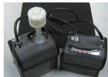
図2. 個人曝露測定用・超低騒音PM10・PM2.5 サンプルシステム
