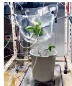
図1. 植物の炭化水素ガスの交換を測定する枝チャンバー法 特殊な透明フッ素樹脂袋で枝葉を囲み、内部に空気を通気します。
