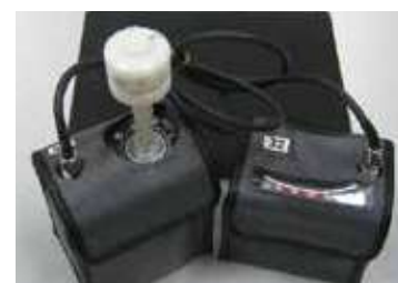
図2. 個人曝露測定用・超低騒音PM10・PM2.5 サンプルングシステム
