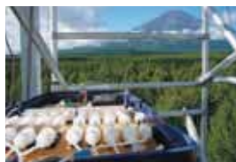
写真3 富士吉田のカラマツ林で、40 mのタワーを用いて、森からの香りの放出を測定
