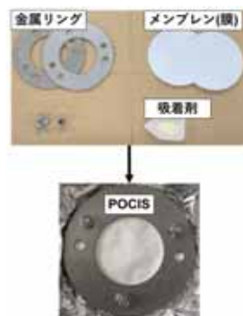
図2 パッシブサンプラーの構成
