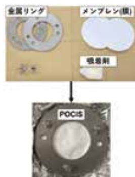
図 2 パッシブサンプラーの構成
