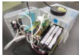
写真4 開発したポータブルCO 2 環境測定器
